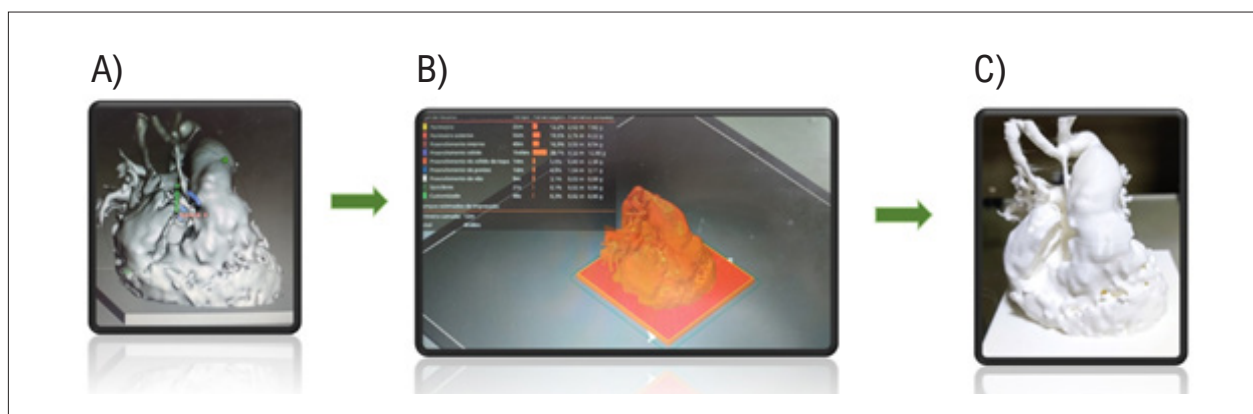
Figura 3 – Construção dos modelos 3D: a) cleaning e smoothing realizados no software; b) modelo estimado para confecção pela impressora; c) modelo produzido (figuras próprias).
